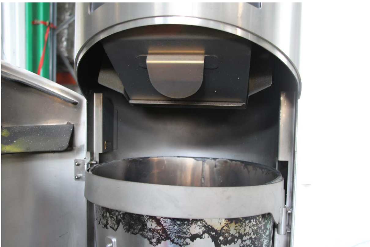
Bild 14: Zeigt die Verfärbungen nach dem Brandversuch am Abfallhai 70 Liter
