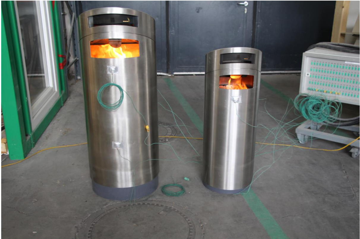
Bild 9: Übersichtsaufnahme beider Abfallbehälter direkt nach der Entzündung der Brandlast
