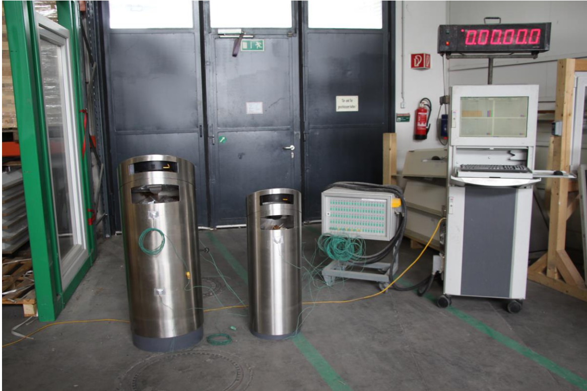
Bild 7: Übersichtsaufnahme der Behälter samt Sonden und Messequipment von vorne und vor dem Brandversuch
