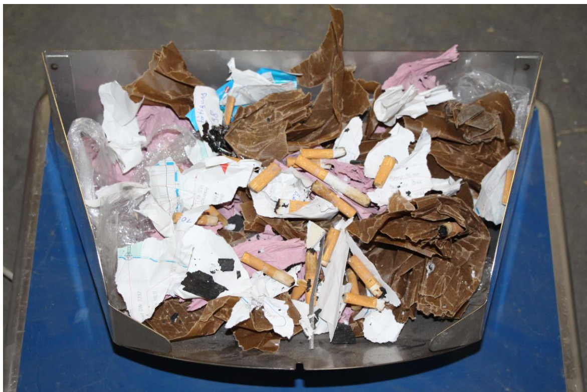
Bild 6: Brandlastbefüllung des Aschers beim 150 Liter-Hai
