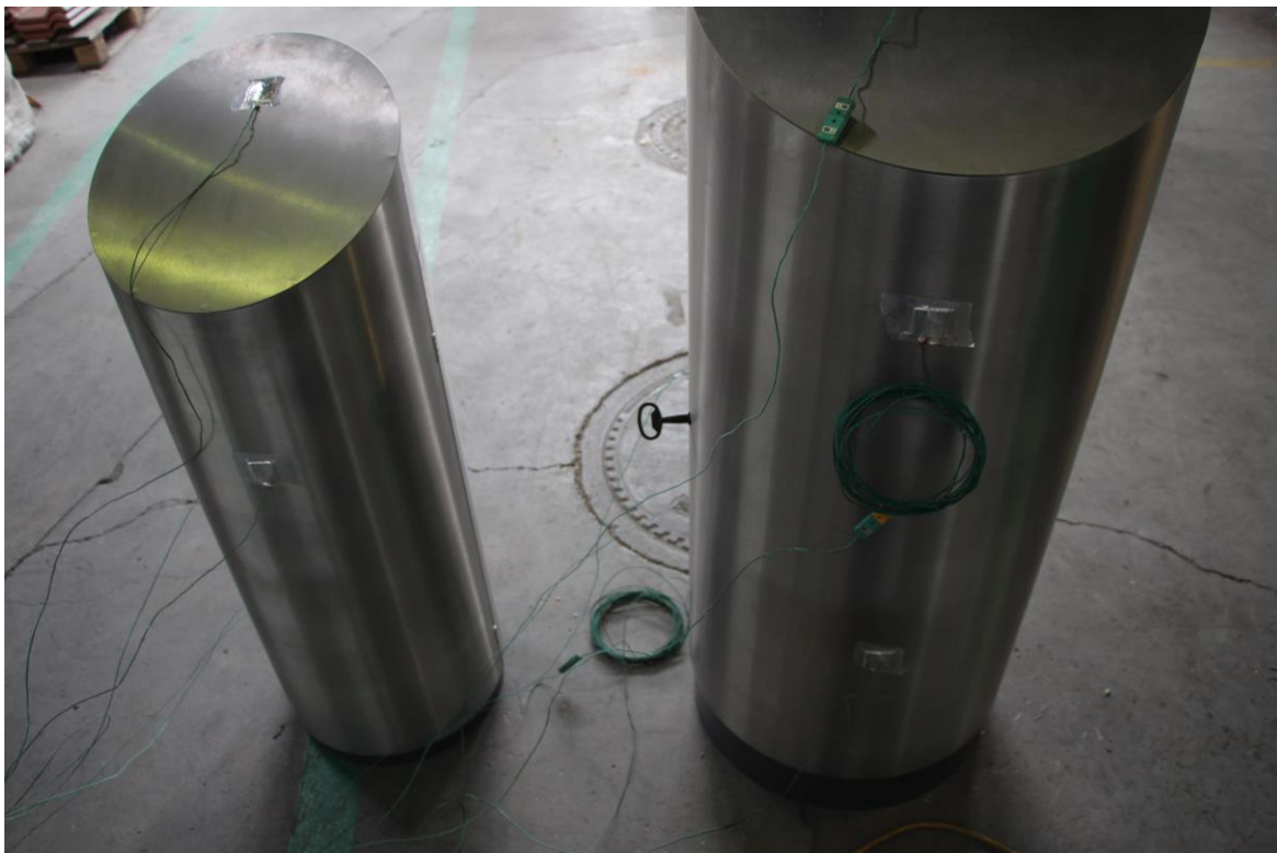
Bild 8: Übersichtsaufnahme der Behälter samt Sonden und Messequipment von hinten und vor dem Brandversuch
