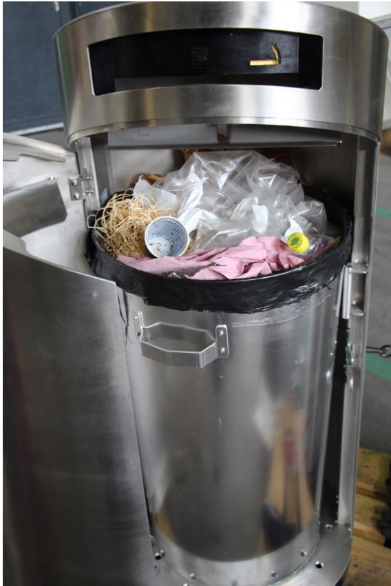
Bild 4: Brandlastbefüllung des 150 Liter-Hai
