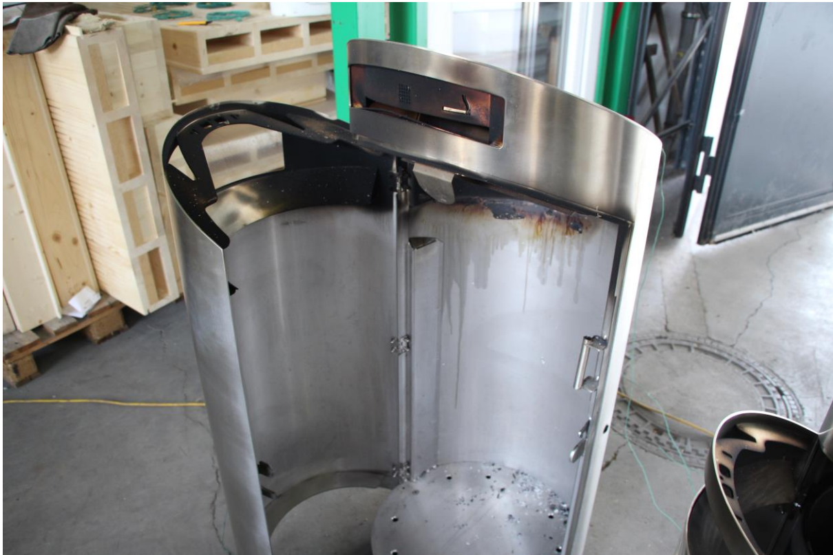
Bild 15: Zeigt die Verfärbungen nach dem Brandversuch am Abfallhai 150 Liter
